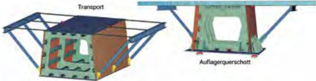
7 *Faltwerkmodelle zur Abbildung der Querrichtung*
