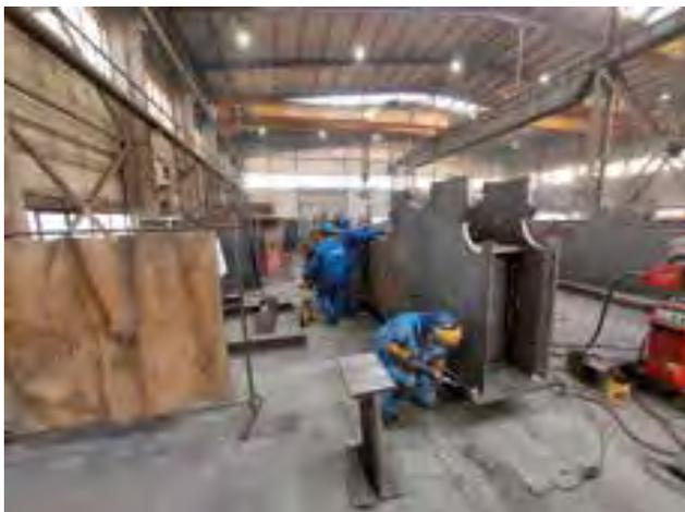
8 Werkseitige Vorfertigung der Stahlkonstruktion © MCE GmbH
