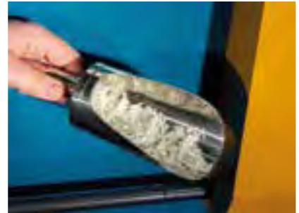
Um die Nachteile der festen Fahrbahn aus Beton zu beheben, entstand die Idee, den Beton durch ein leistungsfähiges Material aus recycelten »Zutaten« zu ersetzen, »zum Beispiel aus alten Rotorblättern von Windkraftanlagen und aus Plastikverpackungen. Vor allem die nach ca. 25 Jahren an ihr Lebensende kommenden Rotorblätter werden bislang kaum nachhaltig wiederverwertet«, so Jonathan Gerstel, wissenschaftlicher Mitarbeiter am Fachgebiet Polymerwerkstoffe und -technologien.
