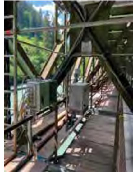
6 Messtechnische Installationen am Stahltragwerk
