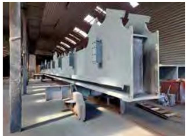
9 Aufbringen des Korrosionsschutzes im Werk © MCE GmbH
