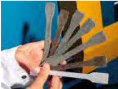
■ Prüfung der Materialkennwerte verschiedener Recyclingmischungen
