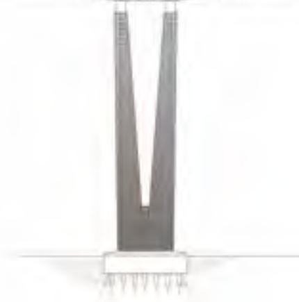
Dort befinden sich Doppelstützen, die jeweils einem Abschnitt zugeordnet sind. Die Länge und die geringe horizontale Steifigkeit der schlanken Stützen begünstigen das Tragverhalten unter Temperaturschwankungen. An den Stützenköpfen sind stehende Stahlbleche angeordnet, die nach dem Einschub mit dem Stahlhohlkasten verschweißt werden. Sie bieten durch ihre Länge und Stärke eine justierbare Rotationsfähigkeit und minimieren die Biegebeanspruchung in den Stützen.
