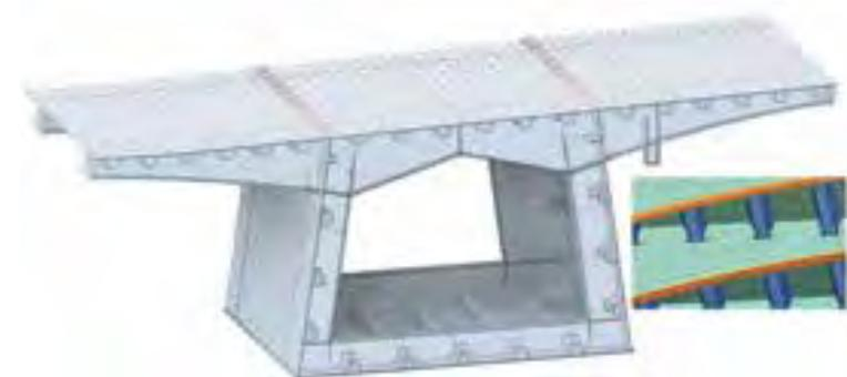
8 BIM-Modell des Kanalquerschnitts mit Orthoverbundplatte und FE-Modellierung
