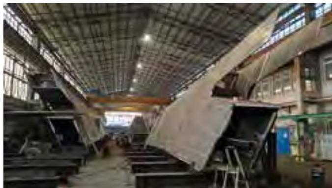
7 Werksfertigung von Segment 7 mit bereits geschlossenen Hauptträgern 1 und 2 © Porr Bau GmbH
