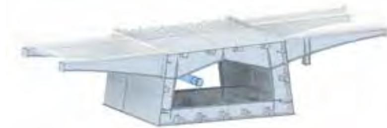
7 BIM-Modell des Regelquerschnitts
