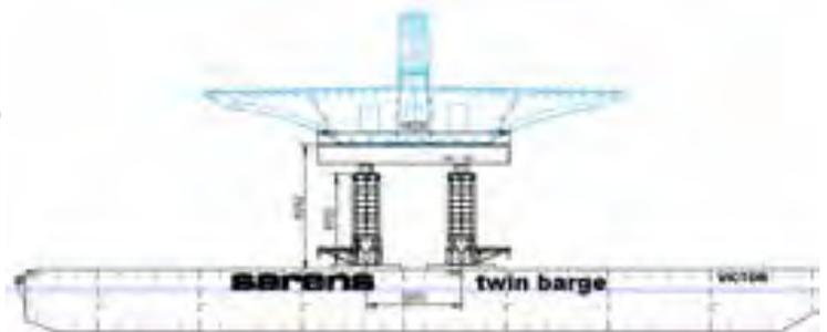
6 7 Elbebrücke Wittenberge: Entwurf von Vorschubgerüst und Ponton © Implenia Civil Engineering GmbH/DSD Brückenbau GmbH
