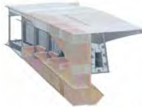
10 Detaillierte Modellierung von Stahlbau und Bewehrung am Hybridpfeiler
