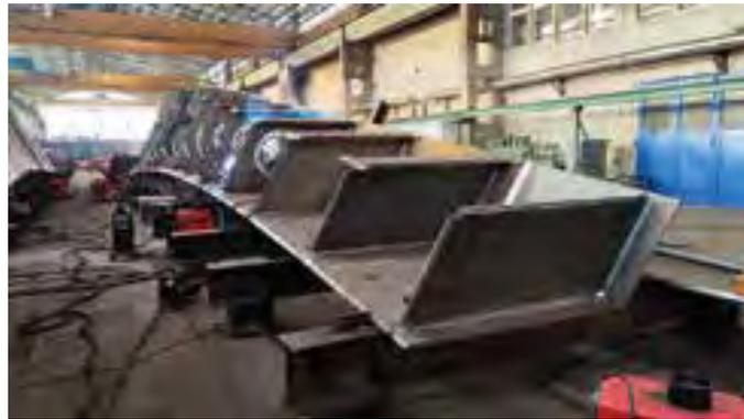
6 Werksfertigung von Segment 5 mit noch offenem Kasten © Porr Bau GmbH
