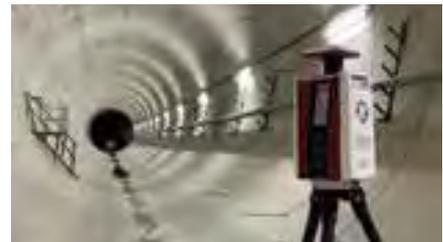
Monitoring und Ebenheitsprüfung in Tunneln
