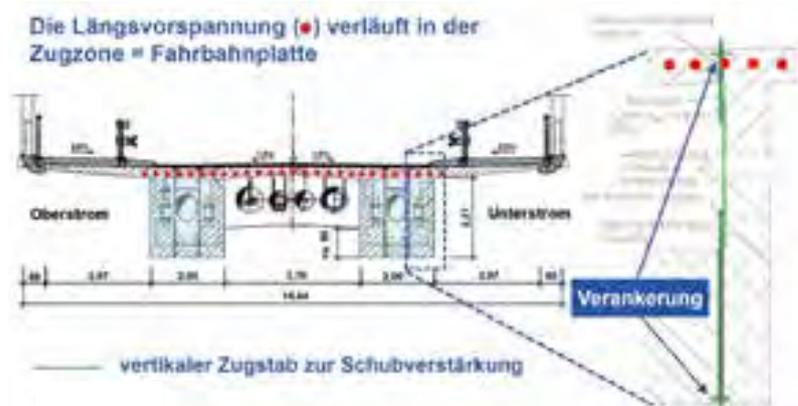
7 Verstärkung der Querkrafttragfähigkeit mit vertikalen Stabspanngliedern
