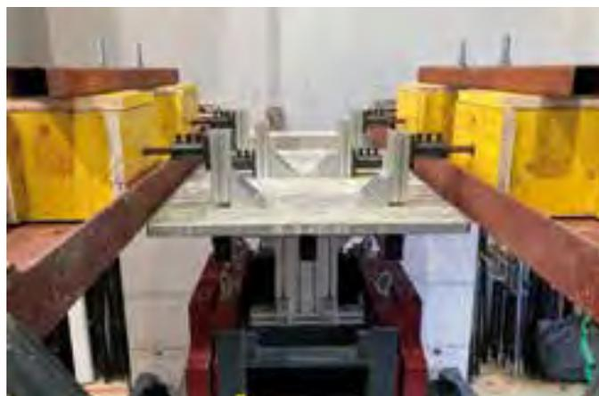
3 Betonproben eingespannt, Erschütterungsanregung des Bewehrungsstabs © Austrian Institute of Technology
